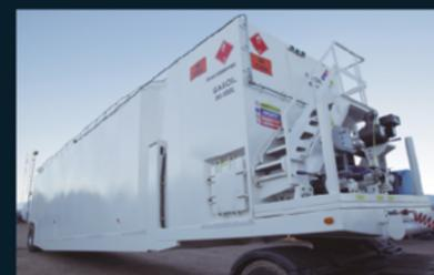
PILETA TANK DIESEL RODANTE
